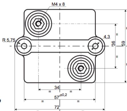
Viti di connessione e fissaggio fornite con il resistore
