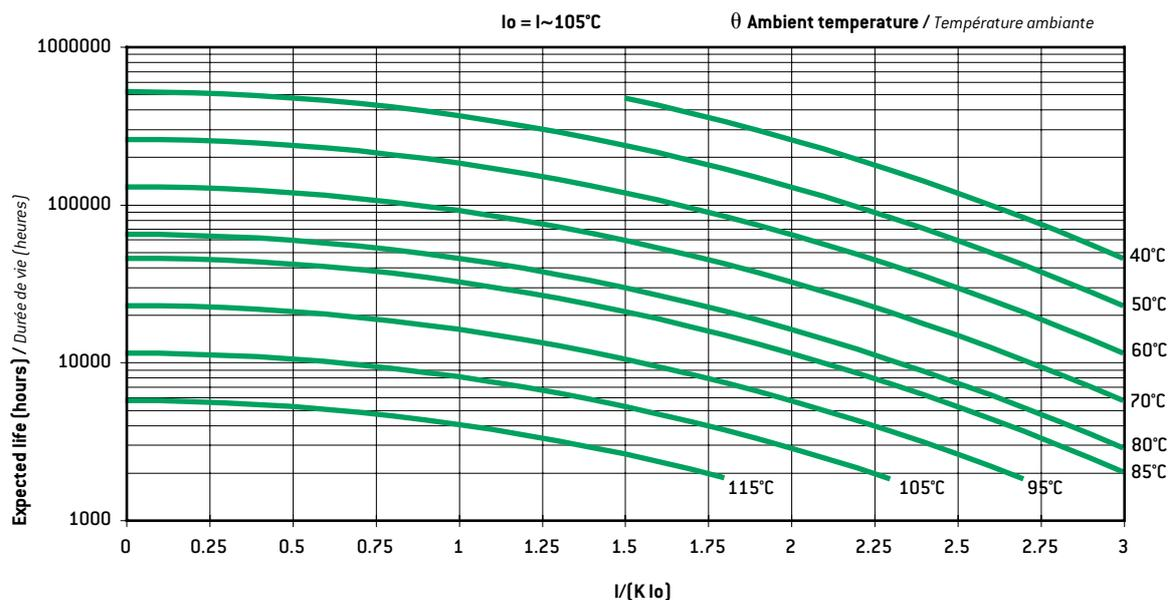
$U_R / U_N \leq 350 \text{ V} : \theta \text{ max } 115^{\circ}\text{C}$
